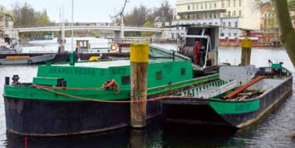
*Fast wie neu sieht der Schwimmdampfbagger aus. Nach der Restaurierung der Außenhaut wurde auch die historische Dampfmaschine wiederhergestellt.*
